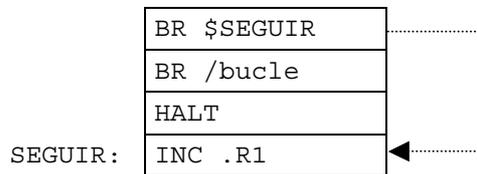
**Figura 4.6.2. Direccionamiento Relativo a PC con etiquetas**
